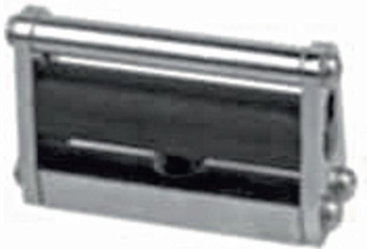
Rollenklemm-Aufsatz für Zug- und Zerreittests bis 5 kN, Gewinde: M10
