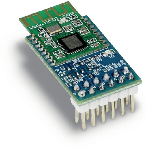
Interfaz de datos Bluetooth para la transmisión de datos inalámbrica al ordenador o a una tablet
