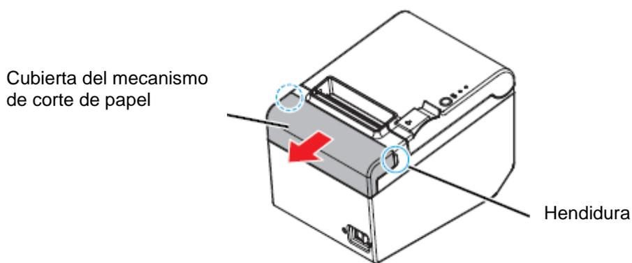
3. Gire la rueda hasta que se vea un triángulo en el agujero. Las cuchillas se encuentran en posición inicial. Consulte las instrucciones de funcionamiento en la parte posterior de la cubierta del mecanismo de corte de papel.
