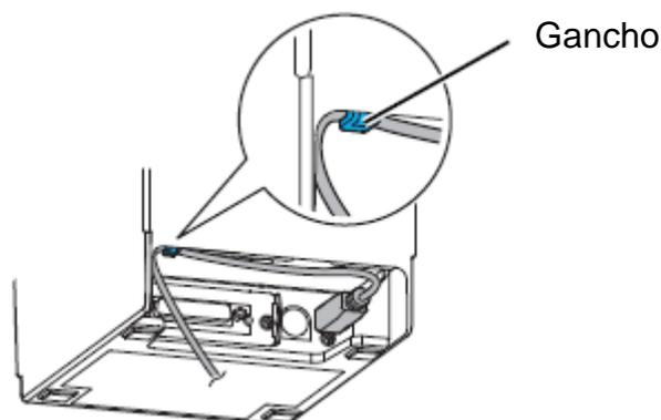
3. Conecte el cable de alimentación al adaptador de red.
