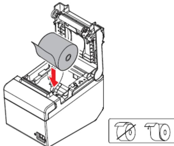
3. Saque un trozo de papel y cierre la cubierta del rollo de papel. Al encender la impresora, el rollo de papel se cortará automáticamente.
