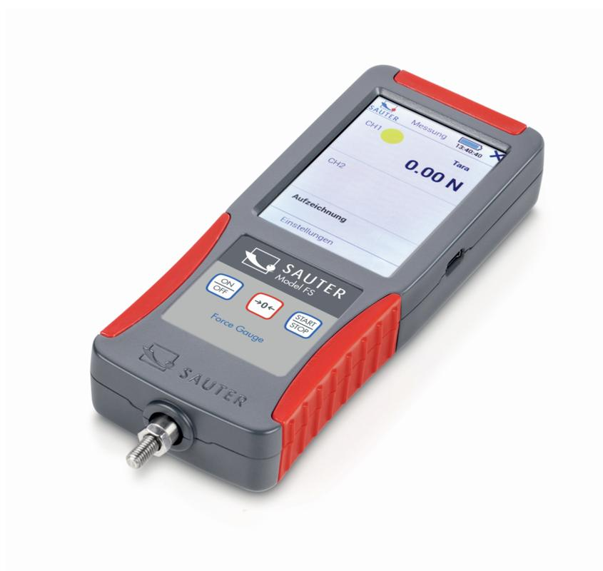
Medidor de fuerza de calidad superior con posibilidad de conexión de hasta 4 células de medición externas
