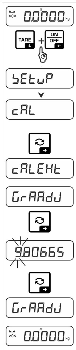
⇒ Pour appeler le menu de configuration, appuyez simultanément sur les touches **TARE** et **ON/OFF**.
