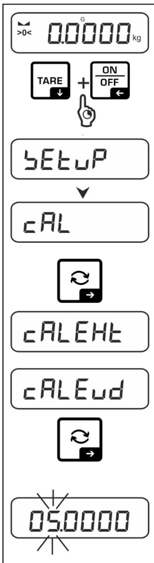
⇒ Pour appeler le menu de configuration, appuyez simultanément sur les touches **TARE** et **ON/OFF**.
