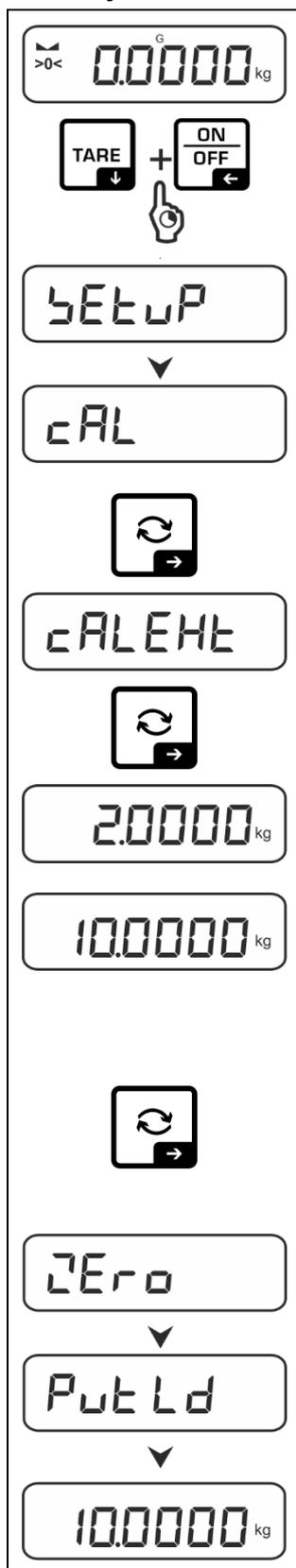
⇒ Pour appeler le menu de configuration, appuyez simultanément sur les touches **TARE** et **ON/OFF**.
