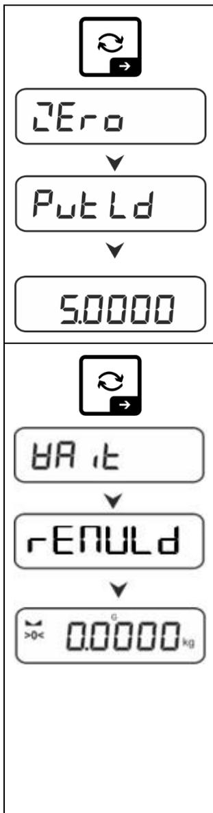
⇒ Validez la sélection en appuyant sur la touche →. L'écran affichera un après l'autre les indications < Zero > et < Put Ld >, suivi de la valeur de masse du poids d'ajustement à placer sur la balance.
