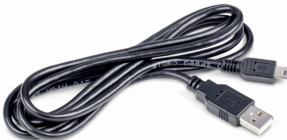
Cable de conexión USB/PC
