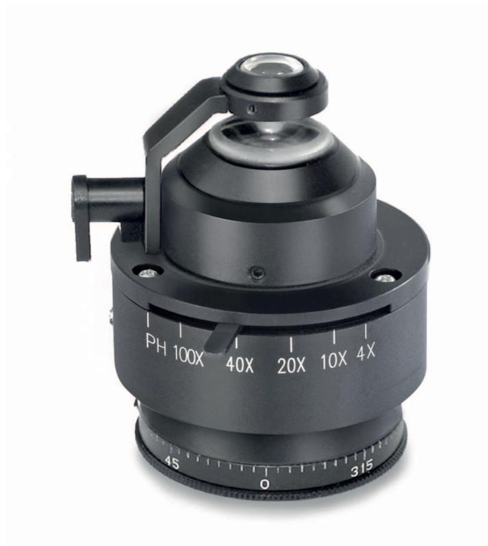
„Swing-out“ Kondensator N.A. 0,9/0,13 zentrierbar (mit Aperturblende)
