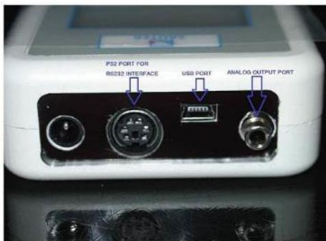
Il y a une sortie analogique sur l'appareil. Cela génère un signal qui va de +2V à -2V. Ce signal est un pourcentage de la valeur maximale du dynamomètre. E.G. : FL100 50N sont mesurés dans le sens de la tension, alors un signal -1 V est présent sur la sortie analogique. 75N en compression, alors + 1.5V est présent à la sortie analogique. Si l'instrument est en mode PASS - Fail, la sortie analogique est de 2V pour PASS et 0V pour FAIL.
