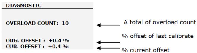
Si le pourcentage de tassement est compris entre 5% et 10%, veuillez contacter le fournisseur pour remplacer la cellule de charge. Ces valeurs sont données à titre indicatif. Le besoin réel d'étalonnage/de remplacement du capteur varie en fonction de ses caractéristiques individuelles.
