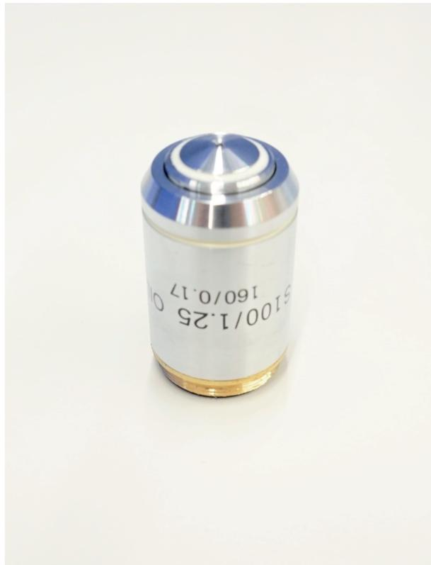
Achromatisches Objektiv, 100 x / 1,25 (Öl) (gefedert) W.D. (0,2 mm)
