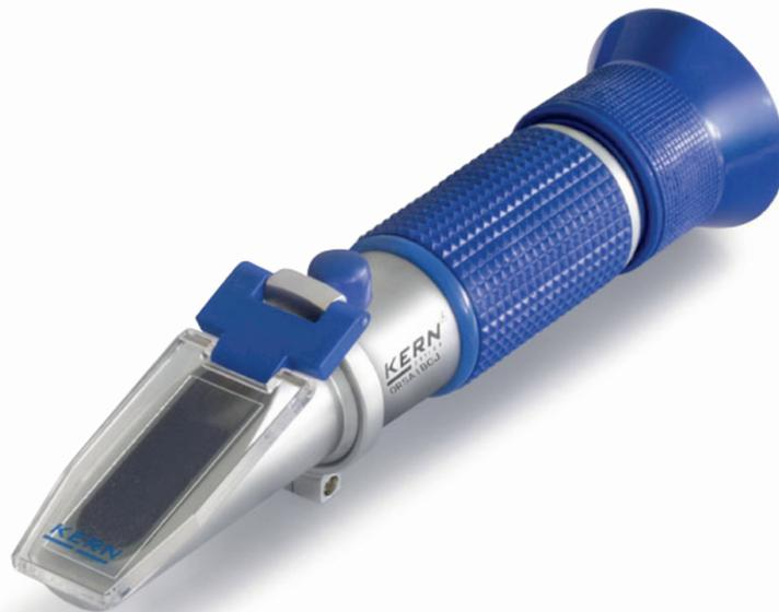
Medición de índice de refracción para laboratorios e industria
