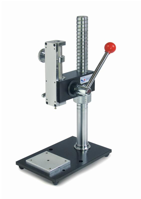
Manueller Prüfstand für Druckkraftmessung
